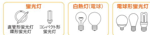
最近照明で話題となっているのが電球形蛍光灯。その名の通り、白熱灯(電球)の形をした蛍光灯で、その特性から、これまでの白熱灯(電球)に替わり得る製品として、注目されています。
